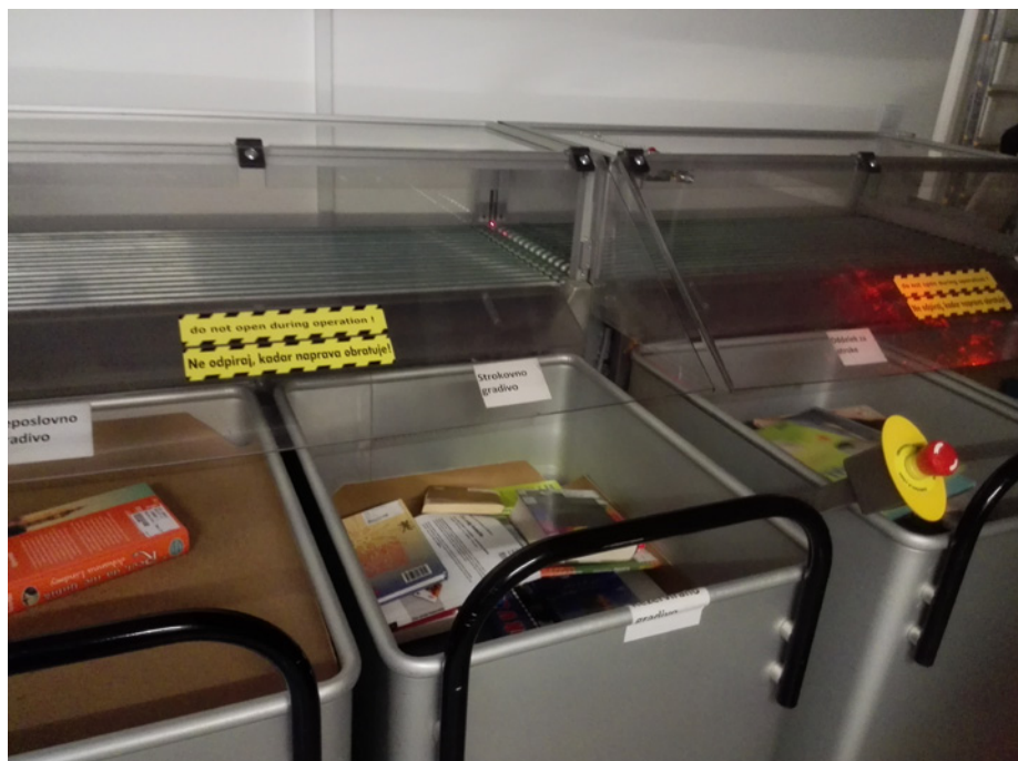
Automatizované třídění vrácených knih v Celje.jpg
